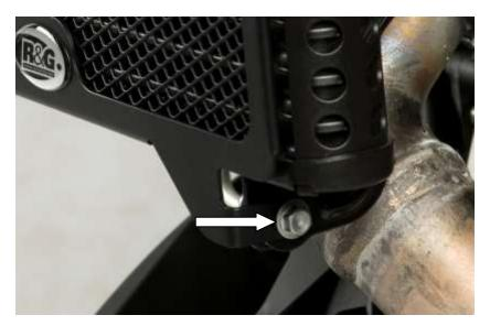
• Fixer ensuite la fixation inférieure gauche à l'aide du collier de serrage livrés dans le kit. (voir la photo).
